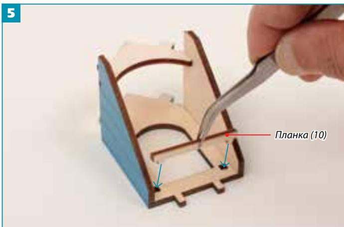
**5** В отверстия фронтальной части эркера вставьте выступы планки (10), закрепите при помощи клея для дерева.
