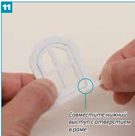
**11** Вставляя верхний выступ в отверстие до упора, расположите окно и раму в одной плоскости.
