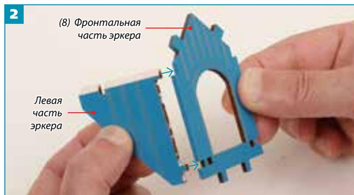
**2** В вырезы детали (8) вставьте выступы детали (7), закрепите при помощи клея для дерева.
